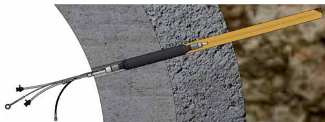
Gespannter Blähpacker mit Entlüftung nach der erfolgreichen Injektion Clamped inflatable packer with ventilation after successful injection
